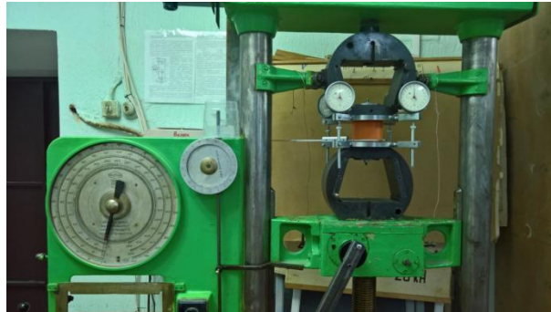
Рисунок 5 – Випробування вкладишу на УМ-5
