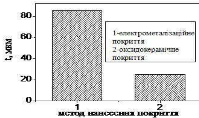
Рисунок 2 – Залежність товщини покриття від методу його нанесення
