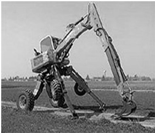
Рисунок 1 – Екскаватор Spider R105
